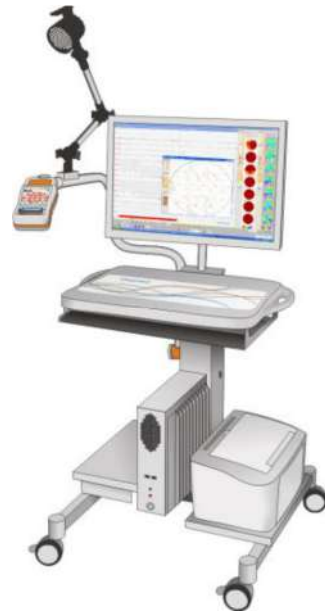
Podstawowy zestaw zamontowany na wózku szpitalnym, wzmacniacz i lampa do fotostymulacji przymocowane do specjalistycznego, ruchomego wysięgnika
