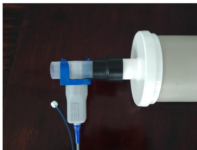
Rys. 5b: Prawidłowo podłączona głowica
