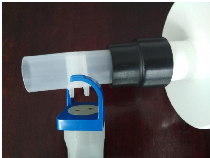
Rys. 5a: Podłączanie głowicy do przewodu powietrznego
