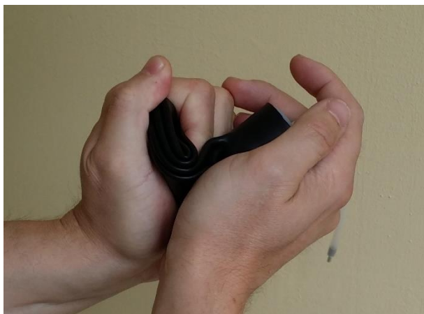
Rys. 6a. Wyciskanie resztek powietrza z worka kalibracyjnego
