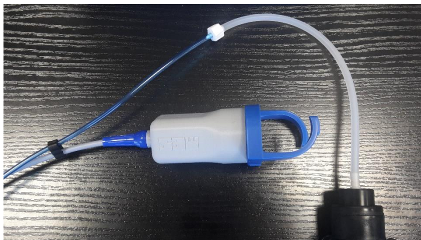
Rys. 6b. Podłączanie worka z gazem do przewodu powietrznego
