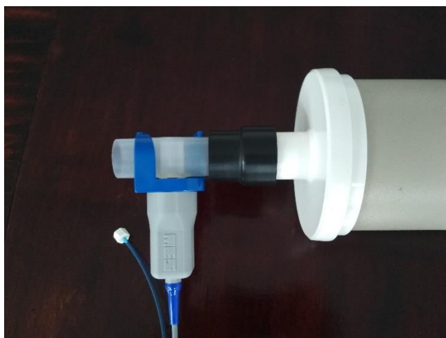
Rys. 5b: Prawidłowo podłączona głowica
