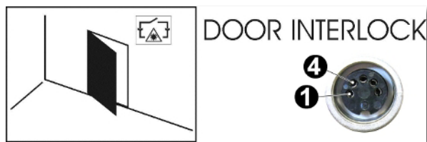
Podłączenie wyłącznika blokowania zdalnego
