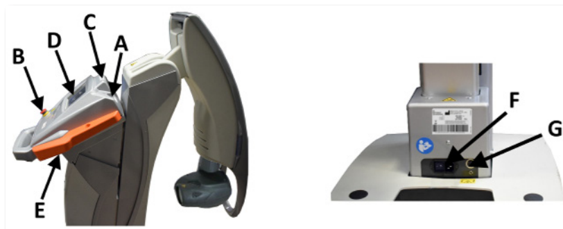
Rozmieszczenie wyłączników, złączy i gniazd
