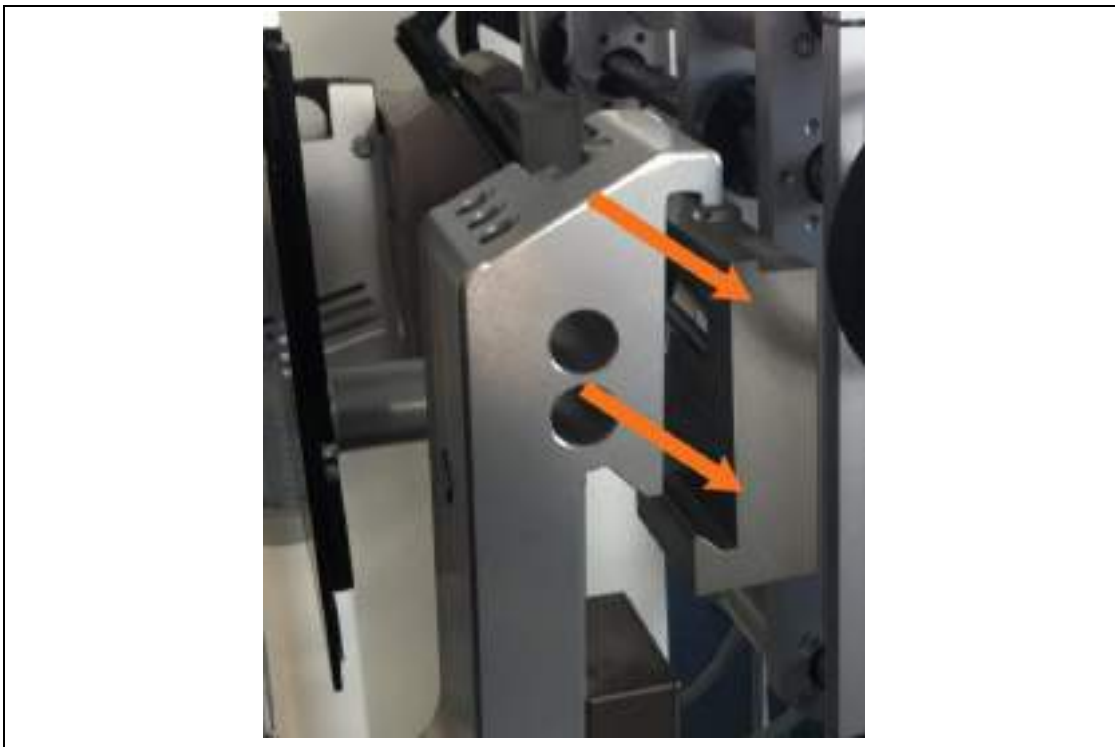
Fig. 41: Montując ortezę należy jednocześnie zahaczyć jej górną część i osadzić dolną część na wsporniku montażowym.
