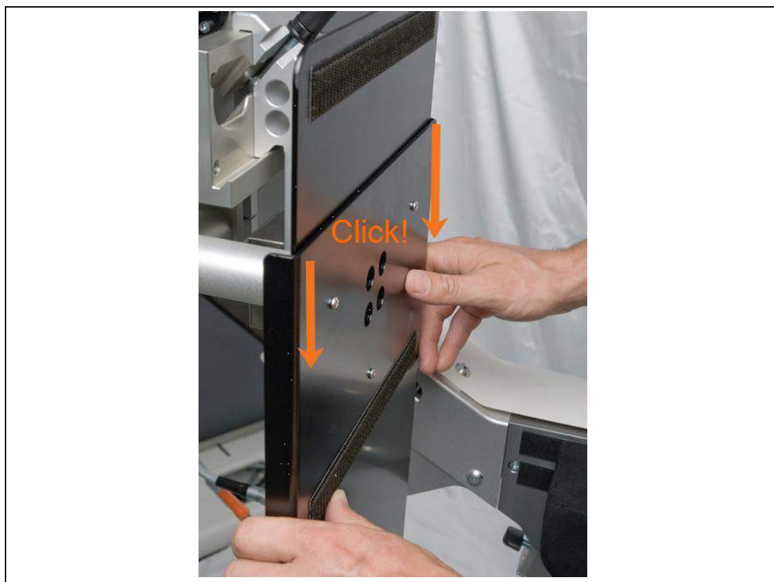
Fig. 44: Upewnij się, że przedłużenie jest odpowiednio zamontowane, przesuwając je w dół, aż do momentu usłyszenia kliknięcia.
