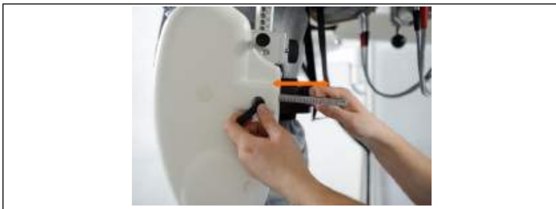
Fig. 84: Regulacja części udowej ortezy w zakresie do przodu/do tyłu w celu dopasowania jej do długości kości udowej pacjenta.
