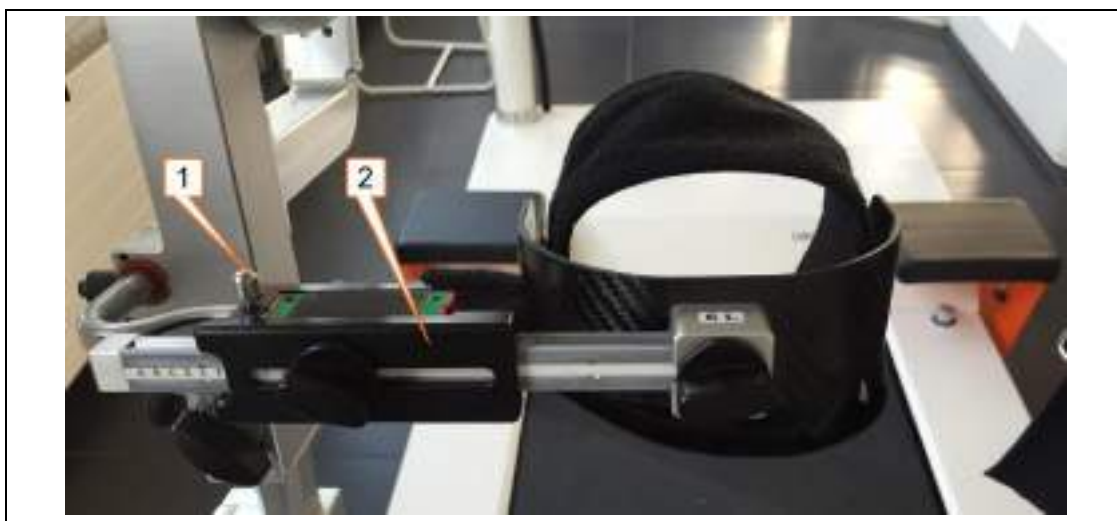
Fig. 130: Mankiet zablokowany. W tym ustawieniu ruch przyśrodkowy lub boczny mankietu nie jest możliwy.
