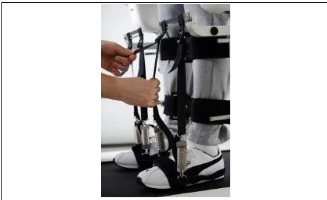
Fig. 91: Naciąganie pasów przy podnośnikach stóp
