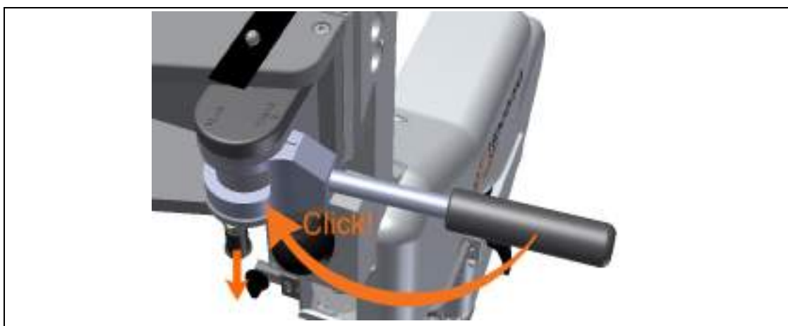
Fig. 50: Pociągnij w dół zawleczkę blokującą i przesunij dźwignię zaciskową w stronę urządzenia, aż usłyszysz kliknięcie.
