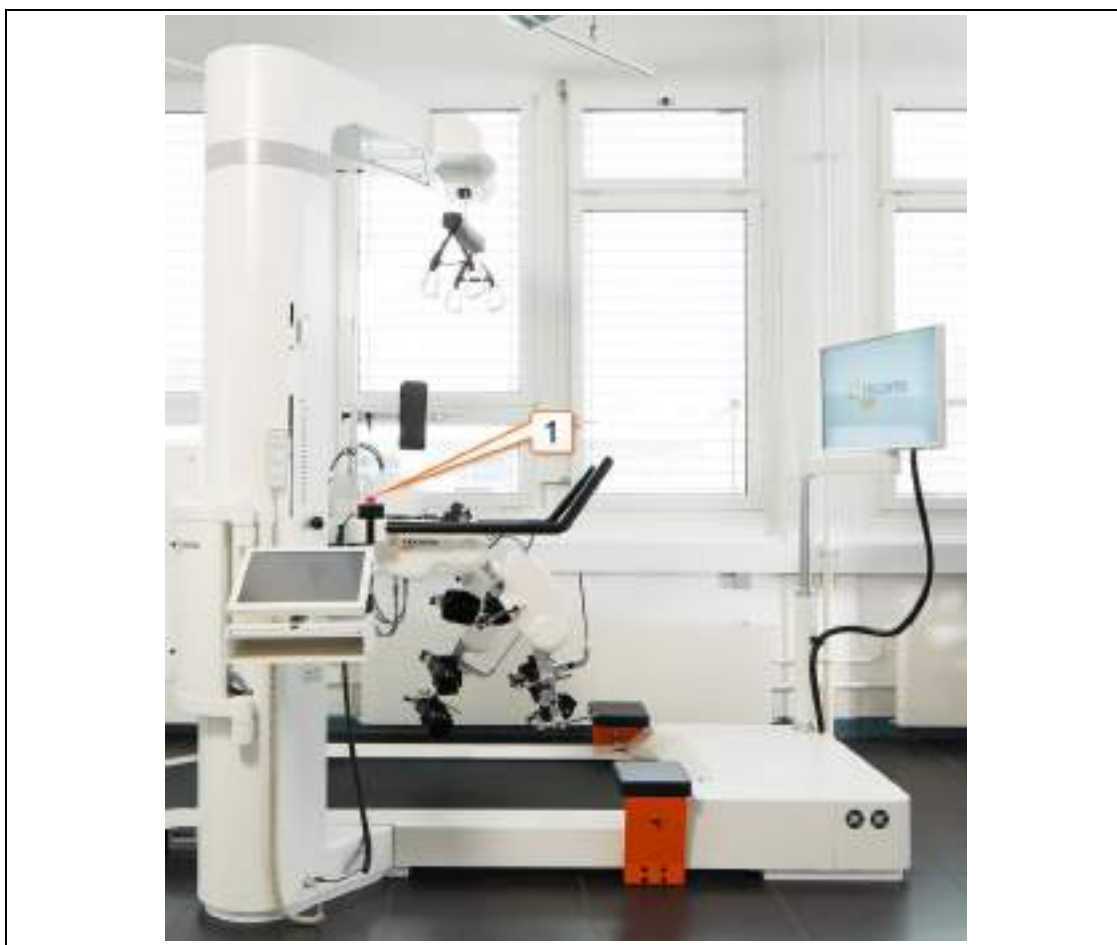
Fig. 27: Wyłączniki awaryjne na urządzeniu Lokomat.
