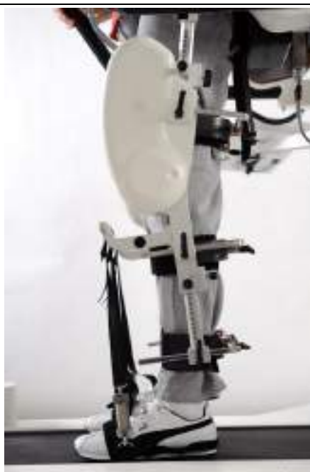
Fig. 127: Stopy z podnośnikami stóp w neutralnej pozycji.
