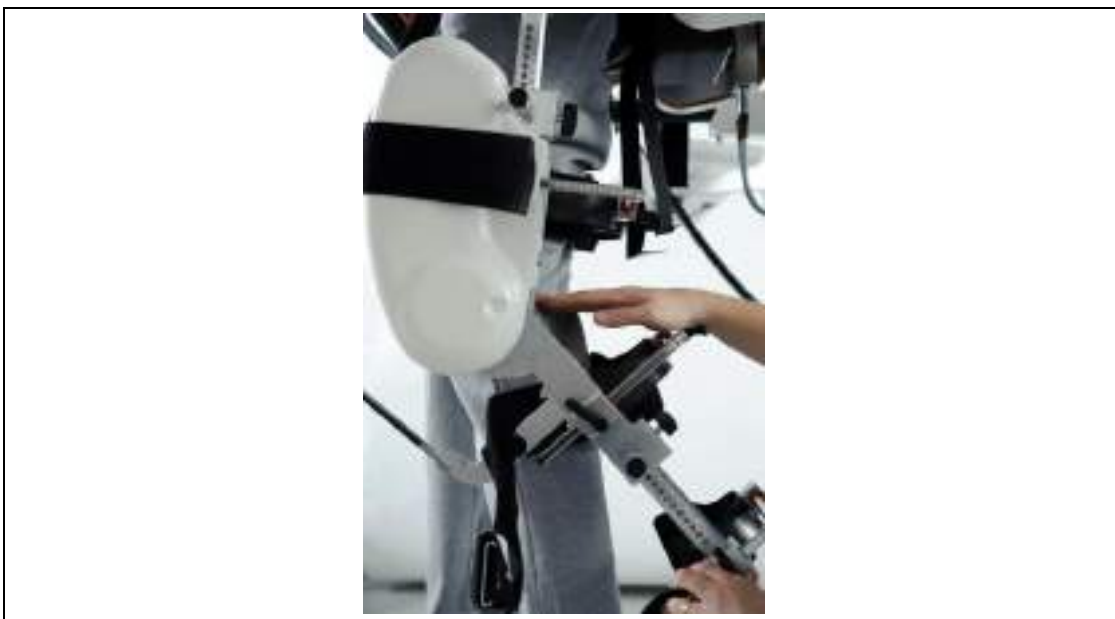
Fig. 82: Sprawdzenie, czy nadkłykcie kolana pacjenta i przeguby stawów kolanowych ortezy urządzenia Lokomat są odpowiednio wyrównane.
