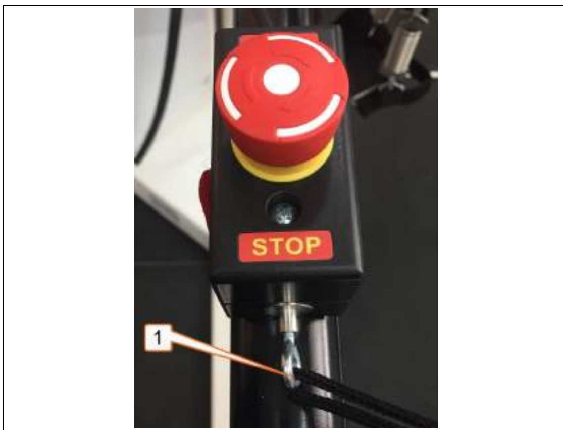
Fig. 28: Szczegółowy wygląd przycisku wyłącznika awaryjnego i magnetycznej linki bezpieczeństwa.
