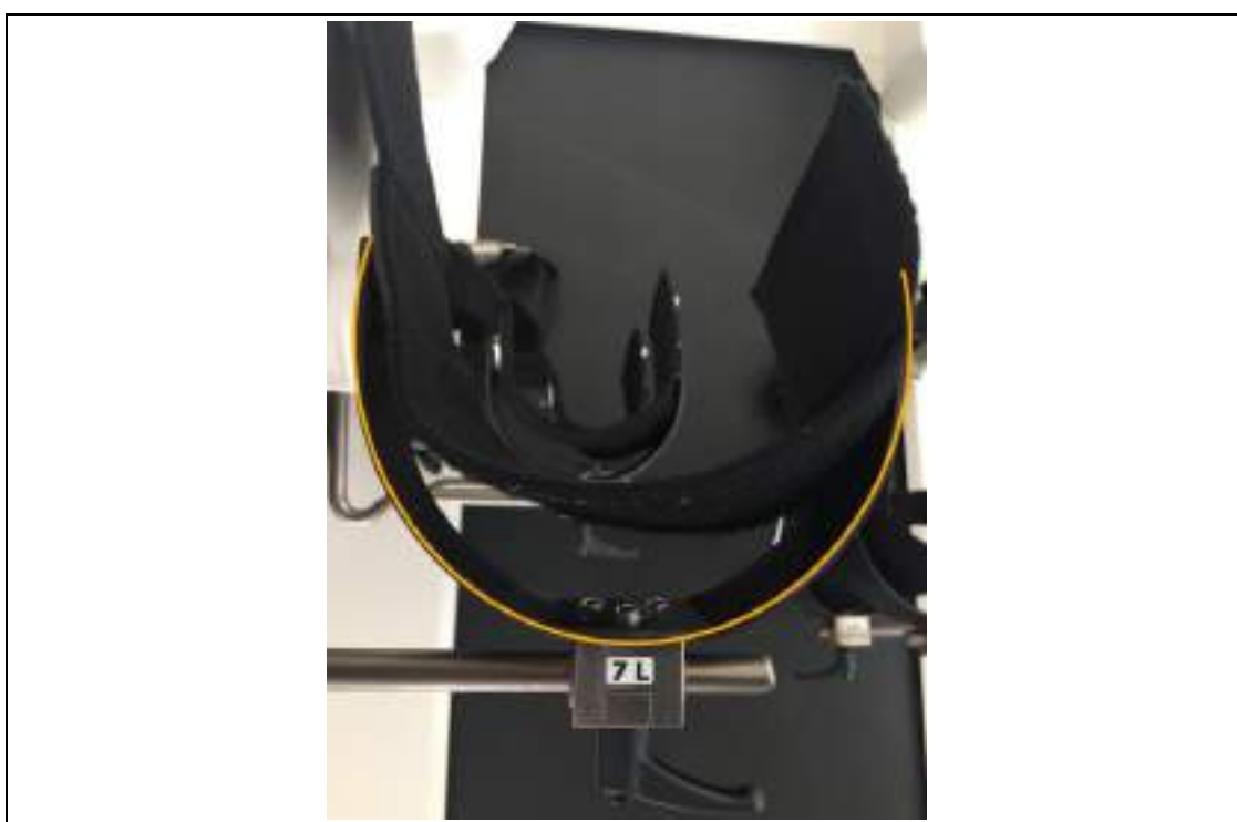
Fig. 101: Górny mankiet bez funkcji FreeD (kształt zaznaczony kolorem pomarańczowym).
