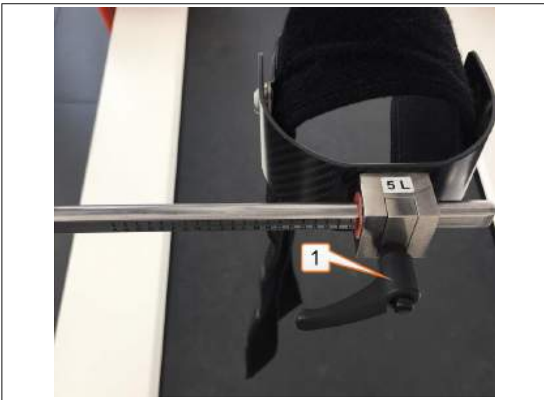
Fig. 69: Mankiety w opcji bez modułu FreeD wyposażone są w śrubę dźwigni zaciskowej.
