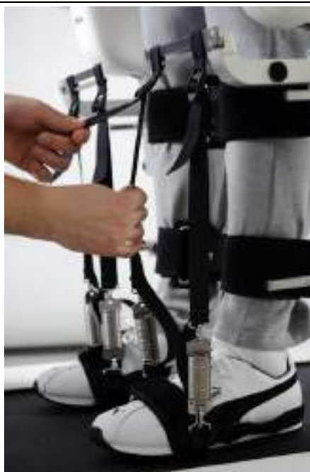
Fig. 126: Naciąganie pasów przy podnośnikach stóp
