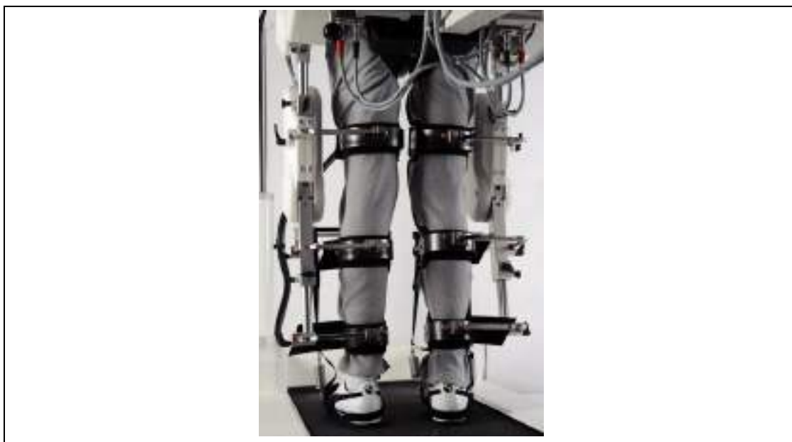
Fig. 88: Poprawnie wyregulowane mankiety w płaszczyźnie czołowej.
