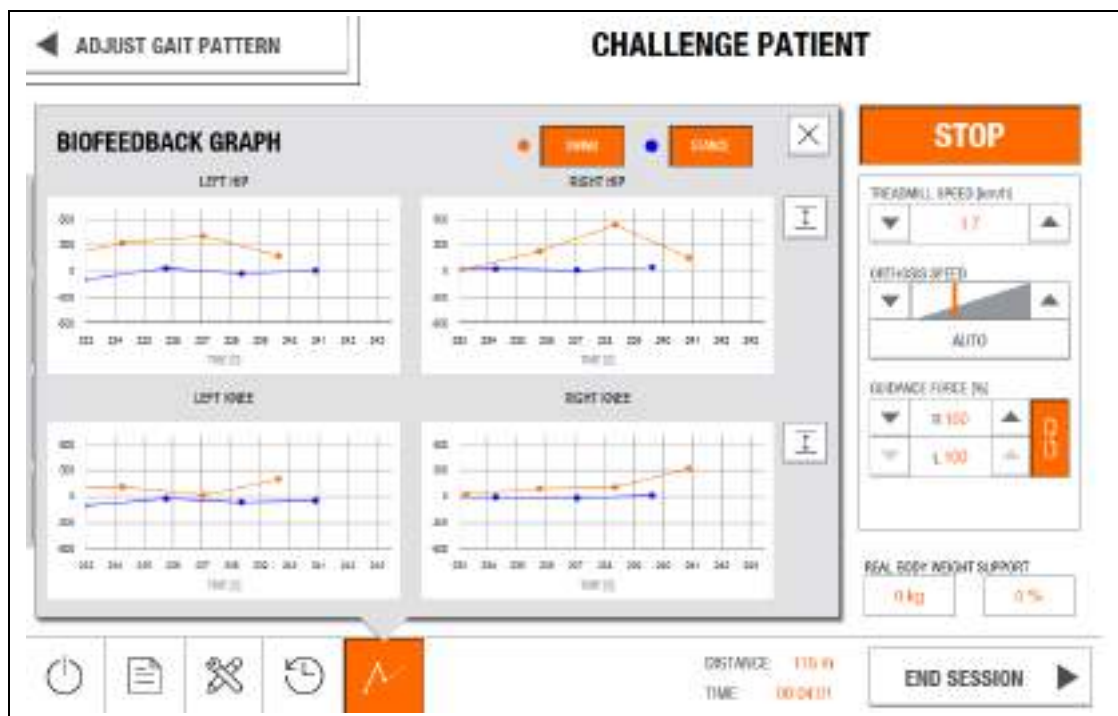
Fig. 162: Wykresy Biofeedback przedstawiają siłę monitorowaną w lewym i prawym stawie biodrowym i kolanowym
