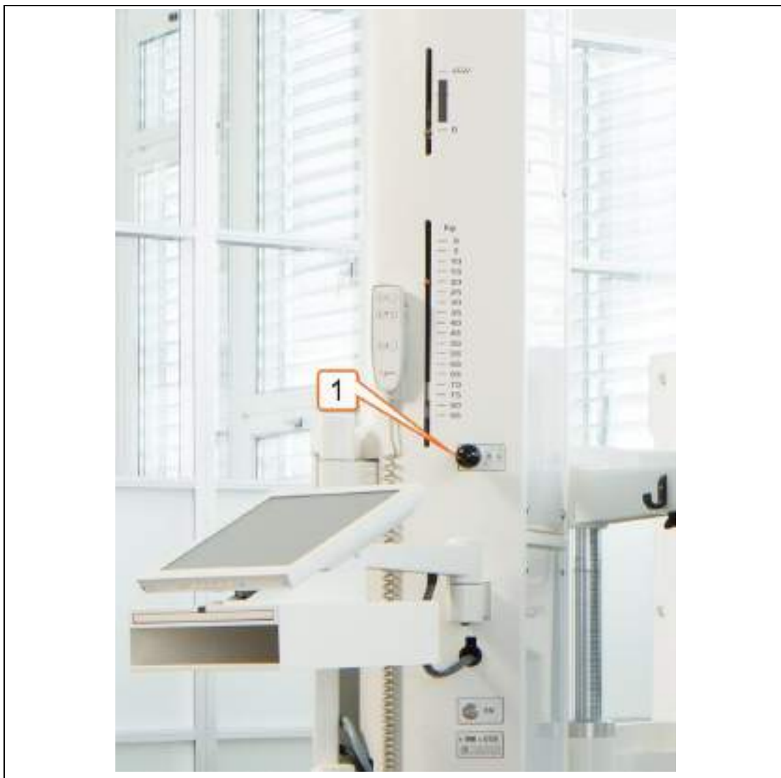
Fig. 9: Gałka zwalniacza awaryjnego na kolumnie podstawy.
