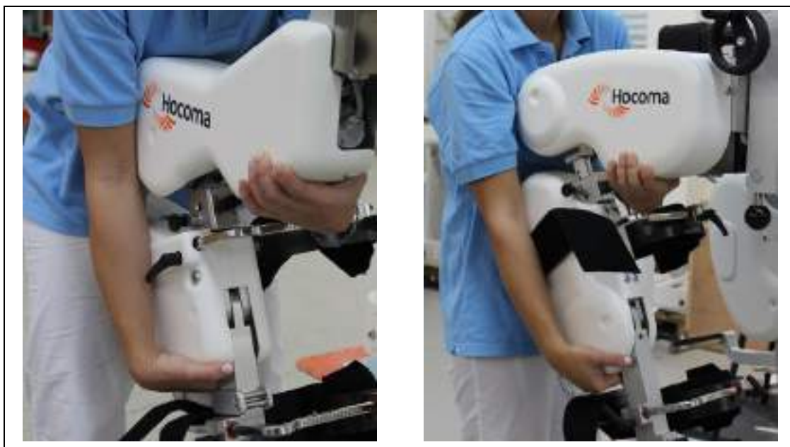
Fig. 40: Orteza pediatriaiczna po lewej stronie, orteza dla dorosłych po prawej. Podczas posługiwania się ortezą pediatriaiczną, zalecamy skrócenie długości nogi do minimum w celu ułatwienia montażu i demontażu.
