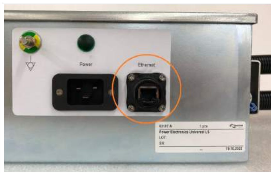
Fig. 172: Podłącz kabel Ethernet do gniazda pod rampą.
