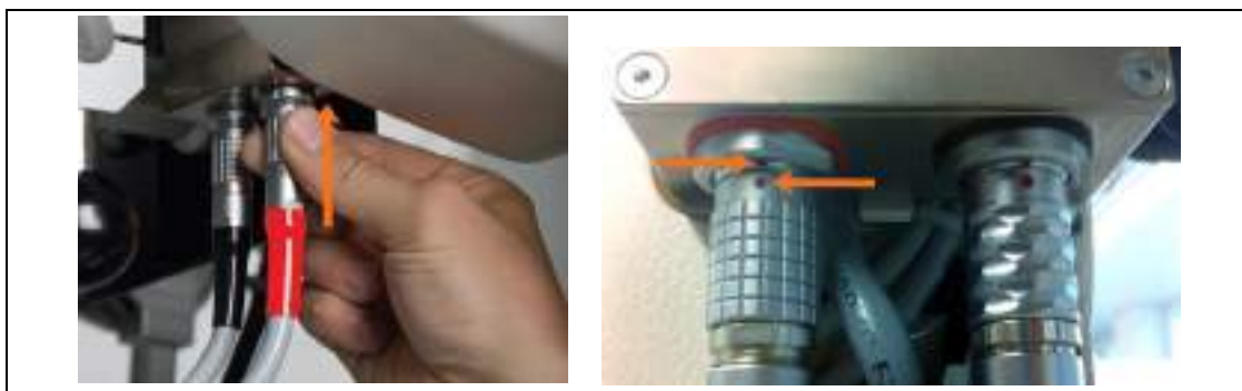
Fig. 43: Wyrównaj kropkę znajdującą się na przewodzie z kropką znajdującą się na gnieździe: kropka skierowana jest do przodu na ortezach dla dorosłych i do tyłu na ortezach pediatrycznych.
