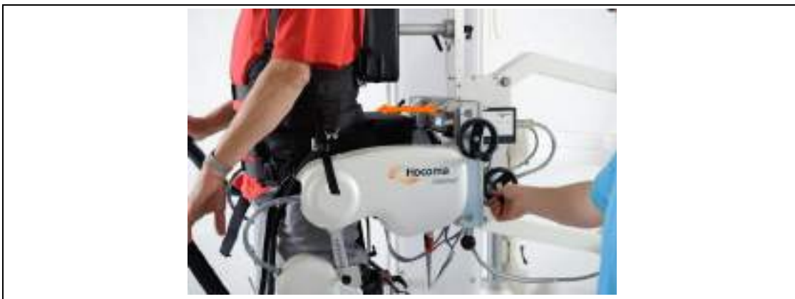
Fig. 77: Użyj dolnego kółka sterującego, aby wyregulować głębokość miedniczną.
