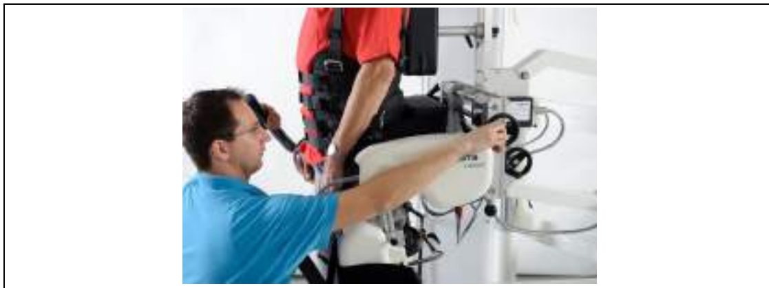
Fig. 79: Obracanie kółka sterującego w celu wyregulowania szerokości ortezy.
