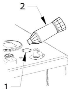
Rys.29. Uzupełnienie zbiornika płynu do dezynfekcji
